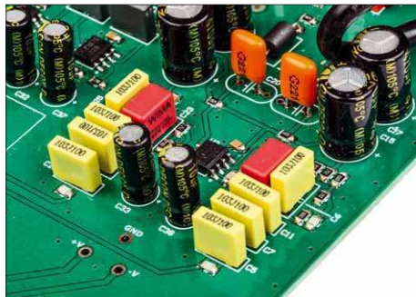
In der Entzerrung kommen bessere und enger tolerierte Bauteile zum Einsatz als beim Vorgänger
